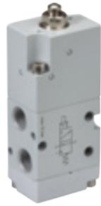
**3/2-Wege-Stößelventil in NC-Ausführung, monostabil mit Federrückstellung**
