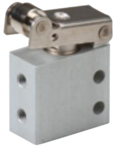
**3/2-Wege-Micro-Rollenhebelventil in NC-Ausführung, monostabil mit Federrückstellung**
